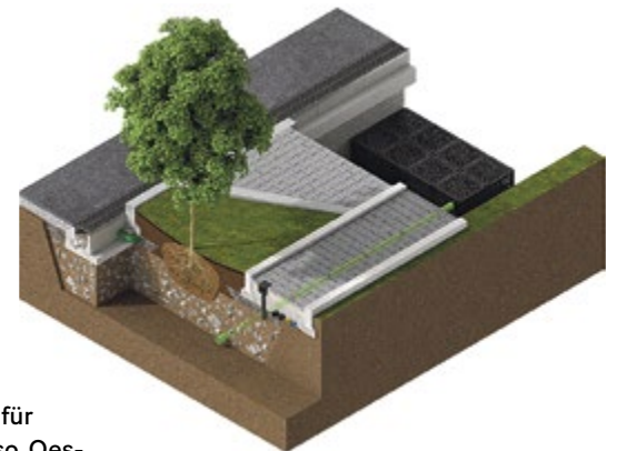
Das System: Gereinigtes Wasser von Verkehrsflächen wird zur Bewässerung von Stadtbäumen genutzt.
